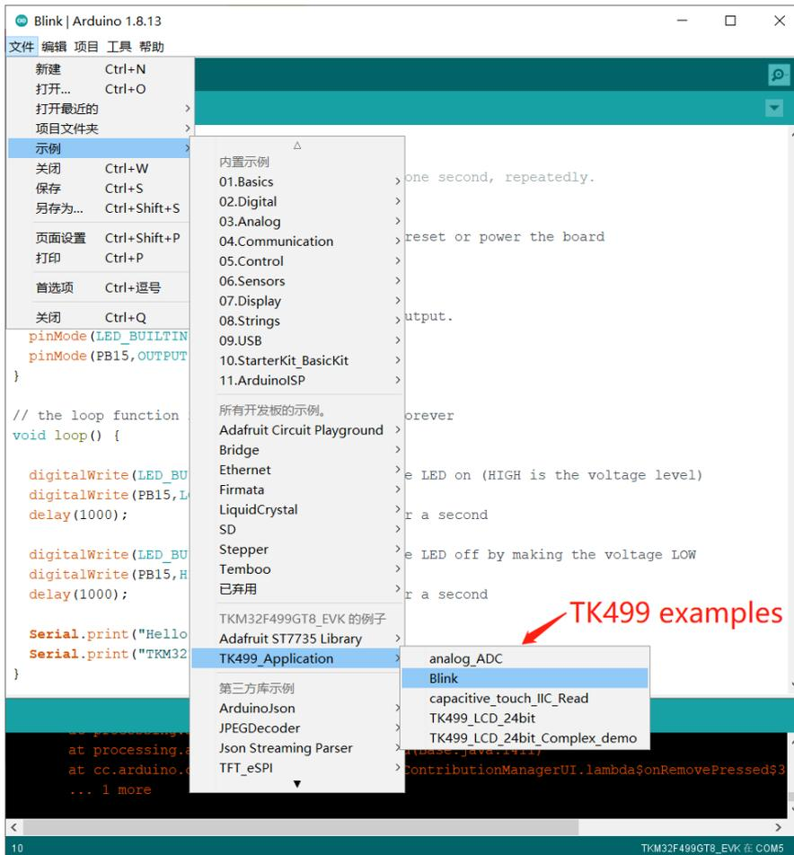
7. 最后, 用 USB 线连接板子, 按 PA1(“up”按键向上推 )->再按“RESET”->松开“RESET”-> 松开“PA1”. (注意: PA1 有两个名字: “up” 或者 “APP”); 然后在 Arduino IDE 中点击“上传”, 程序一会儿就会编译好下载进去。
